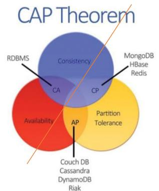
**MongoDB** poskytuje vysokú dostupnosť, škálovateľnosť a partitioning/rozdeľovanie vďaka dokumentovému modelu s dynamickou schémou na úkor konzistentnosti a podpory transakcie.
